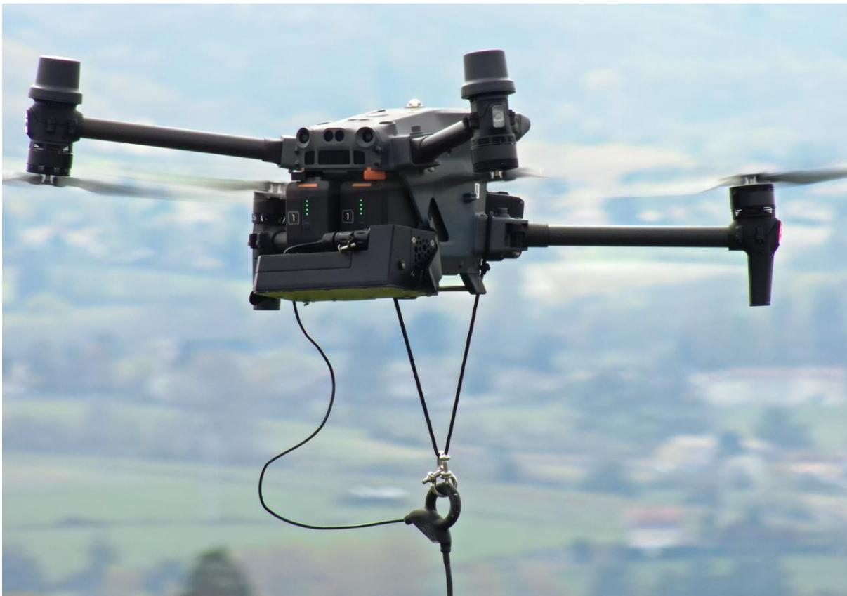
Le module embarqué permettant l'alimentation en filaire ne pèse que 500g et se fixe facilement à l'arrière du drone. Il offre une puissance continue de 1000 Watts permettant de réaliser des heures de vol à 70 mètres sans interruption, et résiste à des températures comprises entre -20 et +50°C. Il permet également à l'opérateur de passer rapidement du mode de vol libre au mode de vol captif.
