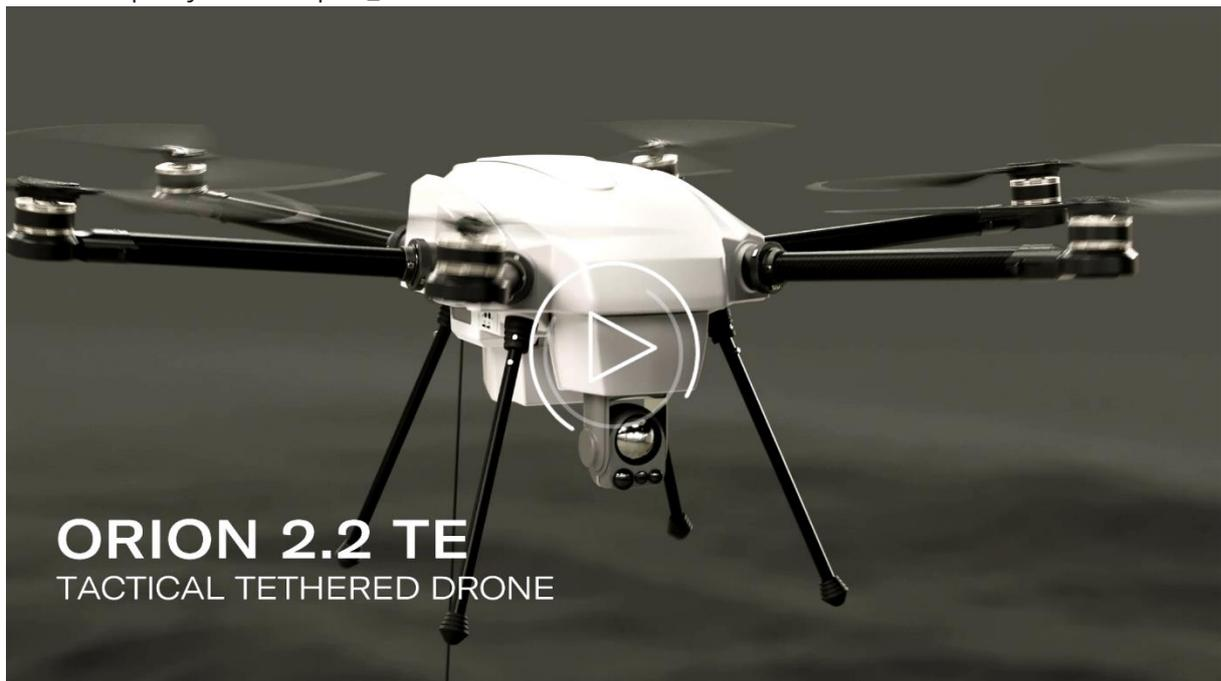
Grâce à l'intégration de la Raptor de Nextvision, de la XQT AI et de la XQT LRF avec télémètre laser jusqu'à 3 km, les opérateurs de l'Orion 2.2 TE bénéficieront d'une qualité vidéo supérieure et des nouvelles fonctions tactiques du logiciel T-Planner V1.2 : suivi de cibles, catégorisation d'objets, routines automatisées, points d'intérêt.
